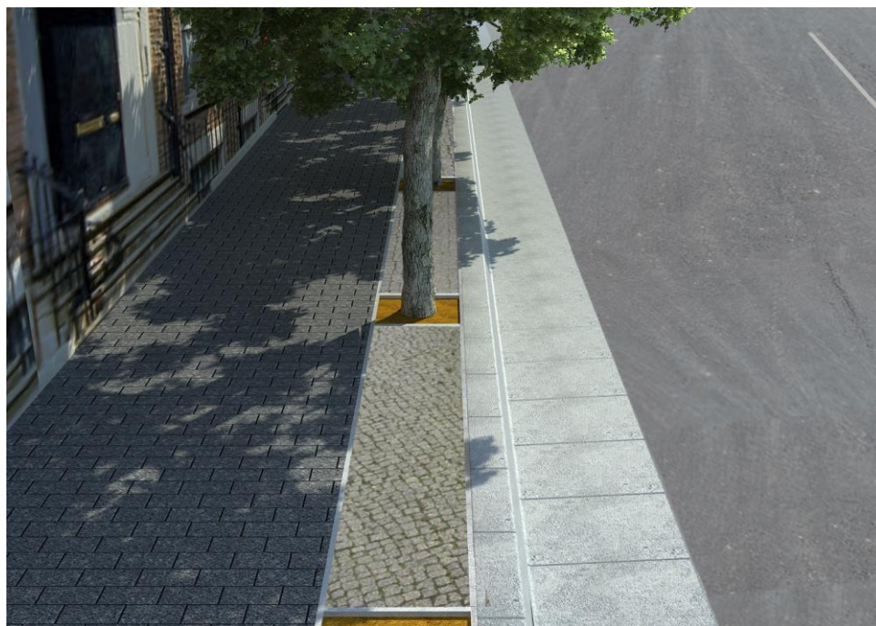
تصویر ۲: نمایش شماتیک اجرای نوار جاذب آب در پیاده‌رو
