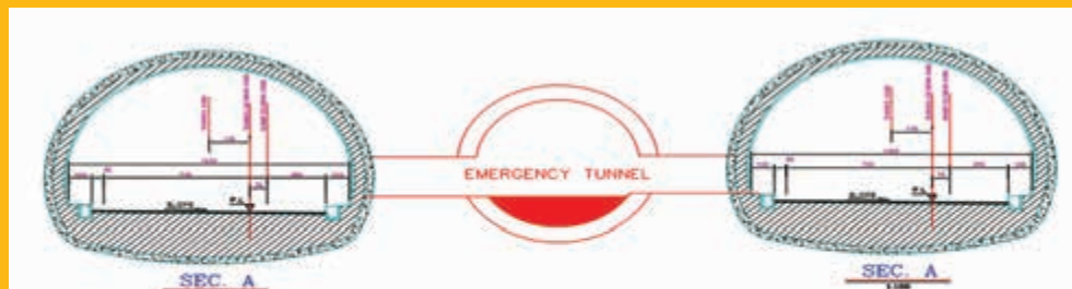
مقطع عرضی تونل صدر (دورشته تونل رفت و برگشت و تونل دسترسی اضطراری)
